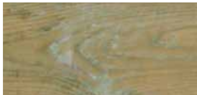
Residui del trattamento in autoclave
